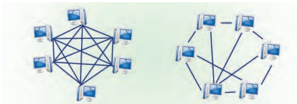
شکل ۱۶- همبندی مش ناقص و کامل
